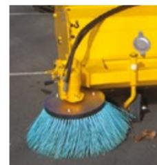
Balai latéral Ø 700 mm avec moteur, flexibles, vanne 3 voies
