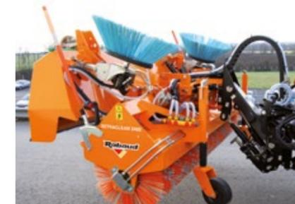
SETRACLEAN avec option bac de ramassage, pour fonction 2 en 1 aligneuse / ramasseuse
