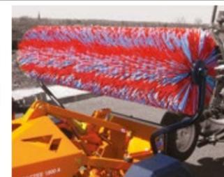
Support balai de rechange avec un moyeu et 36 anneaux
