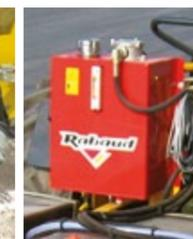
Centrale hydraulique PDF 540 Tr/min
