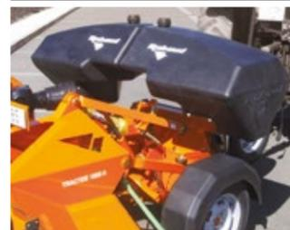
Arrosage par gravité ou par pression avec 2 cuves 150 L et rampe 6 jets
