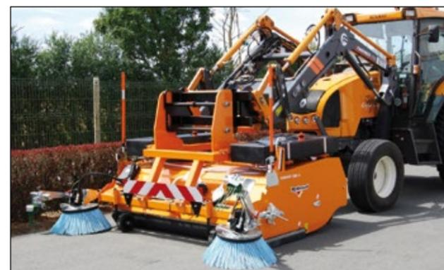
TURBONET avec options : Chargeur frontal, Balais latéraux, Griffes de nettoyage, Kit de signalisation, Arrosage par pression avec 2 cuves à eau de 100 litres, Peinture spécifique (RAL 2000).
