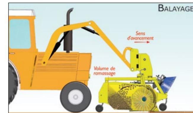
Principe de ramassage dans le sens de l'avancement - BREVETÉ
