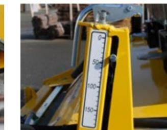
Réglage de la hauteur du balai par une simple manivelle
