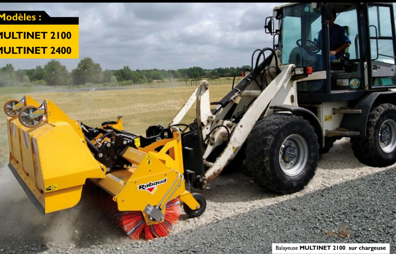
Balayeuse **MULTINET 2100** sur chargeuse
