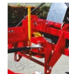
Interface mixte pour adaptation sur 2<sup>ème</sup> porteur type télescopique
