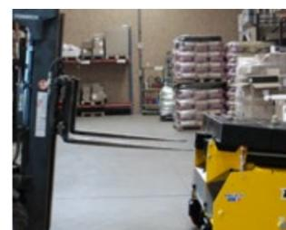
Accrochage sans descendre du chariot (pas de connexions hydrauliques et électriques)
