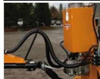
Centrale hydraulique pompe double corps avec réservoir d'huile, cardan et électrodistributeur
