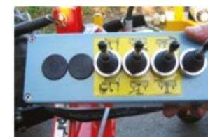
Commande électro-hydraulique depuis le poste de conduite (option)
