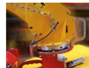
Goulotte d'évacuation montée sur couronne à billes facilement orientable sur 360° + capteur de sécurité zone d'alimentation
