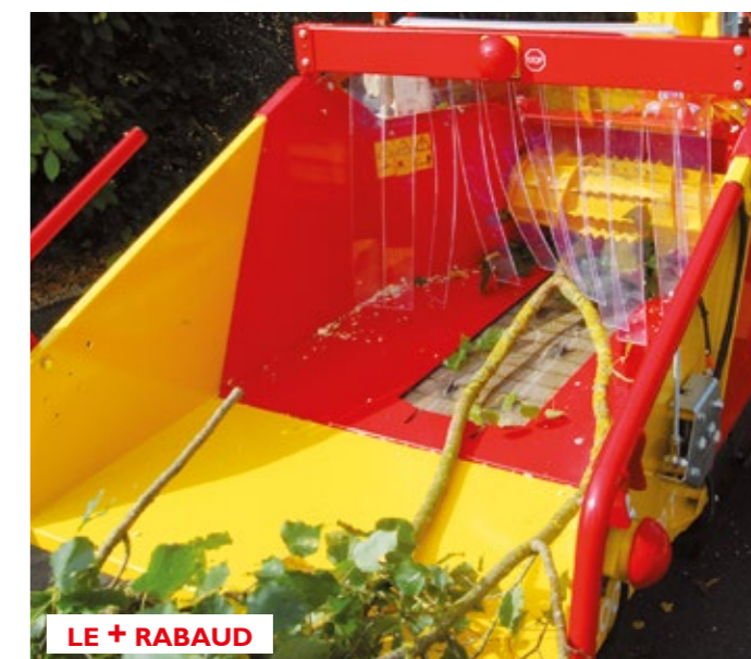
Rouleau d'alimentation surdimensionné et à pas convergents. Option : tapis ameneur avec crochets pour plus de confort d'utilisation. Capot translucide sur la trémie pour plus de visibilité.
