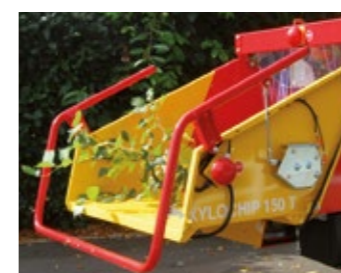
Barre de sécurité 4 positions + 3 boutons d'arrêt d'urgence
