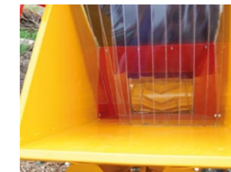
Trémie d'alimentation avec rouleau surdimensionné
