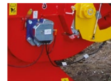
NOSTRESS pour la régulation électronique du rouleau d'alimentation
