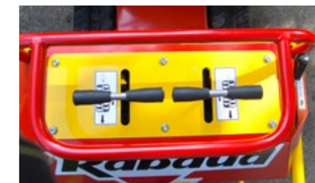
Commandes type "mini-pelle" pour ergonomie totale
