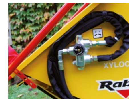
Molette de réglage de l'avancement du rouleau d'alimentation
