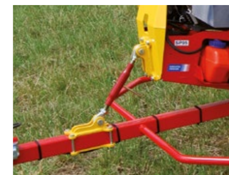
Réglage de l'inclinaison du châssis selon la hauteur d'accrochage
