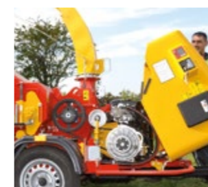
Capot en polyester pour un accès facile aux organes de la machine.
