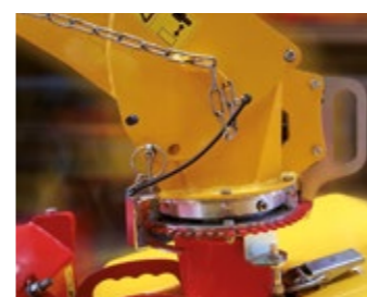
Goulotte d'évacuation montée sur couronne à billes facilement orientable sur 360° + capteur de sécurité zone d'alimentation
