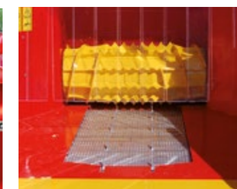
Tapis d'alimentation avec crochets pour une meilleure préhension des branches
