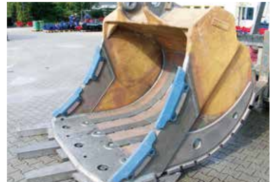
Nach der Reparatur mit neuem Boden, Messer, Zähnen und Verschleißschutz
