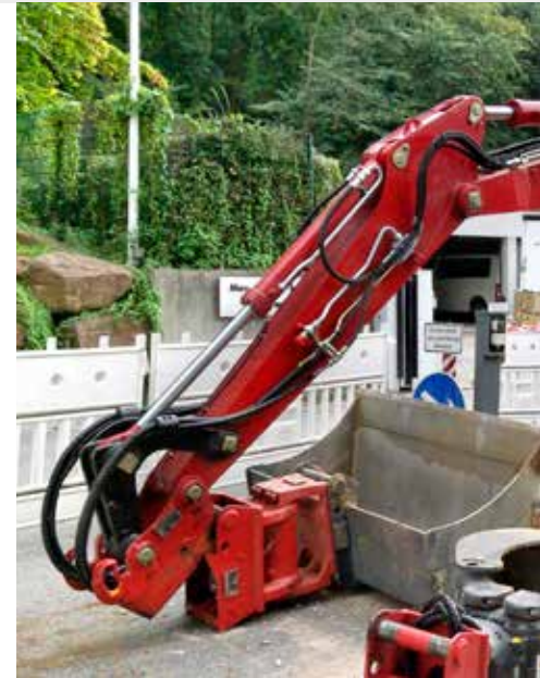
Tilt-Schnellwechsler in Sandwich-Bauweise kann bei Bedarf wie ein Anbaugerät abgelegt werden
