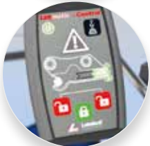
Schnellwechsler korrekt verriegelt
