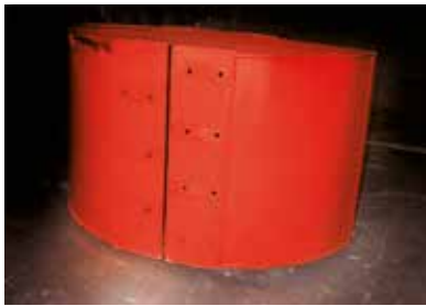
Umbau eines handelsüblichen 2-Schalengreifers
