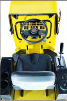
Siège ergonomique antivibratile avec contacteur de sécurité
