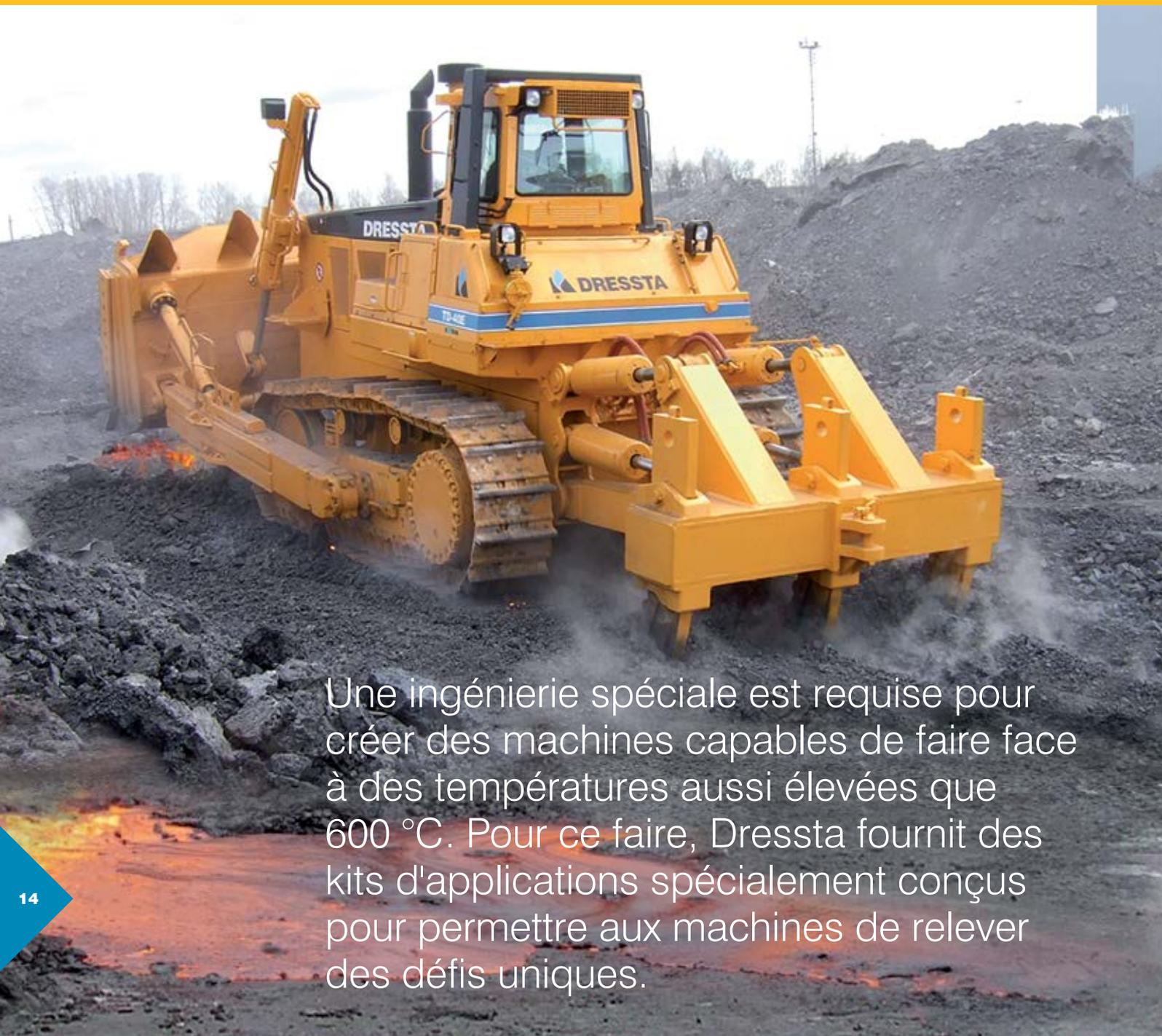
Une ingénierie spéciale est requise pour créer des machines capables de faire face à des températures aussi élevées que 600 °C. Pour ce faire, Dressta fournit des kits d'applications spécialement conçus pour permettre aux machines de relever des défis uniques.
