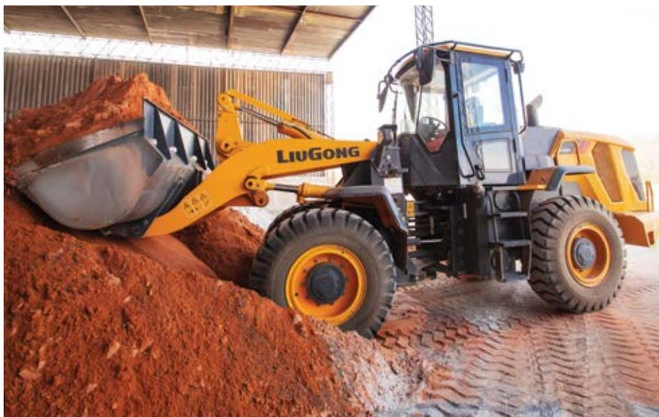
La cabine protège l'opérateur du bruit et des vibrations et est bien ventilée. Le contrôle avancé de la température permet de s'ajuster aux changements des saisons et est complètement scellé afin de prévenir la contamination par la poussière.
