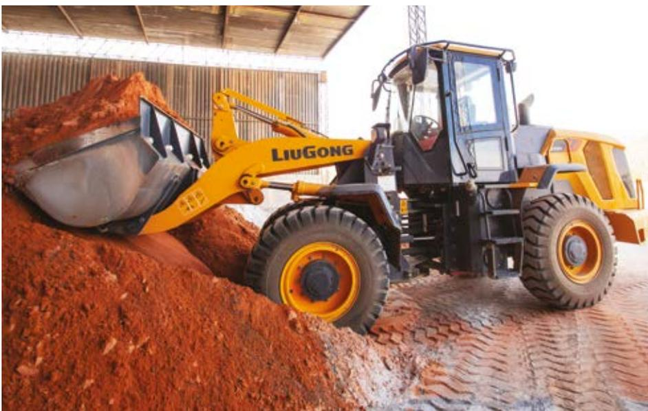
Die Kabine schützt den Bediener vor Lärm und Vibrationen und ist gut belüftet. Sie ist mit einer modernen Klimaanlage ausgestattet, um den wechselnden Jahreszeiten gerecht zu werden, und ist vollständig versiegelt, um zu verhindern, dass Staub in den Arbeitsplatz eindringt.
